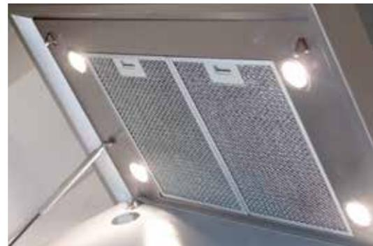
**Inselhaube 900 x 600 mm aus Edelstahl, aufklappbare Randabsaugung aus Glas (weiß) vor der Filterfläche zur Erhöhung der Ansauggeschwindigkeit, mit integriertem Hochleistungsgebläse mit Motor, LED-Spots zur Kochstellenausleuchtung**
