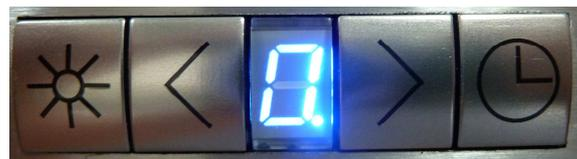
Der Anlernmodus wird durch den blinkenden Dezimalpunkt am Bedienteil des Lüfters sichtbar. Ist die Fernbedienung angelernt, erlischt der Dezimalpunkt und das Licht schaltet ein.
